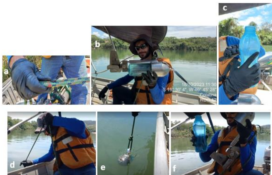
Figura 6 - Corda graduada (a); amostrador para descarga sólida (b); detalhe da marcação na garrafa de 1L para o volume de recuperação de amostra aceitável (entre 700 mL e 800mL) (c); descida do equipamento utilizando a corda graduada (d); equipamento posicionado horizontalmente à água (e); amostra de água coletada com aproximadamente 800 mL (f)
