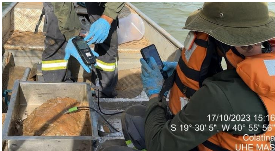
Figura 5 – Verificação de “Eh” em sedimento no ponto amostral UHE MAS
