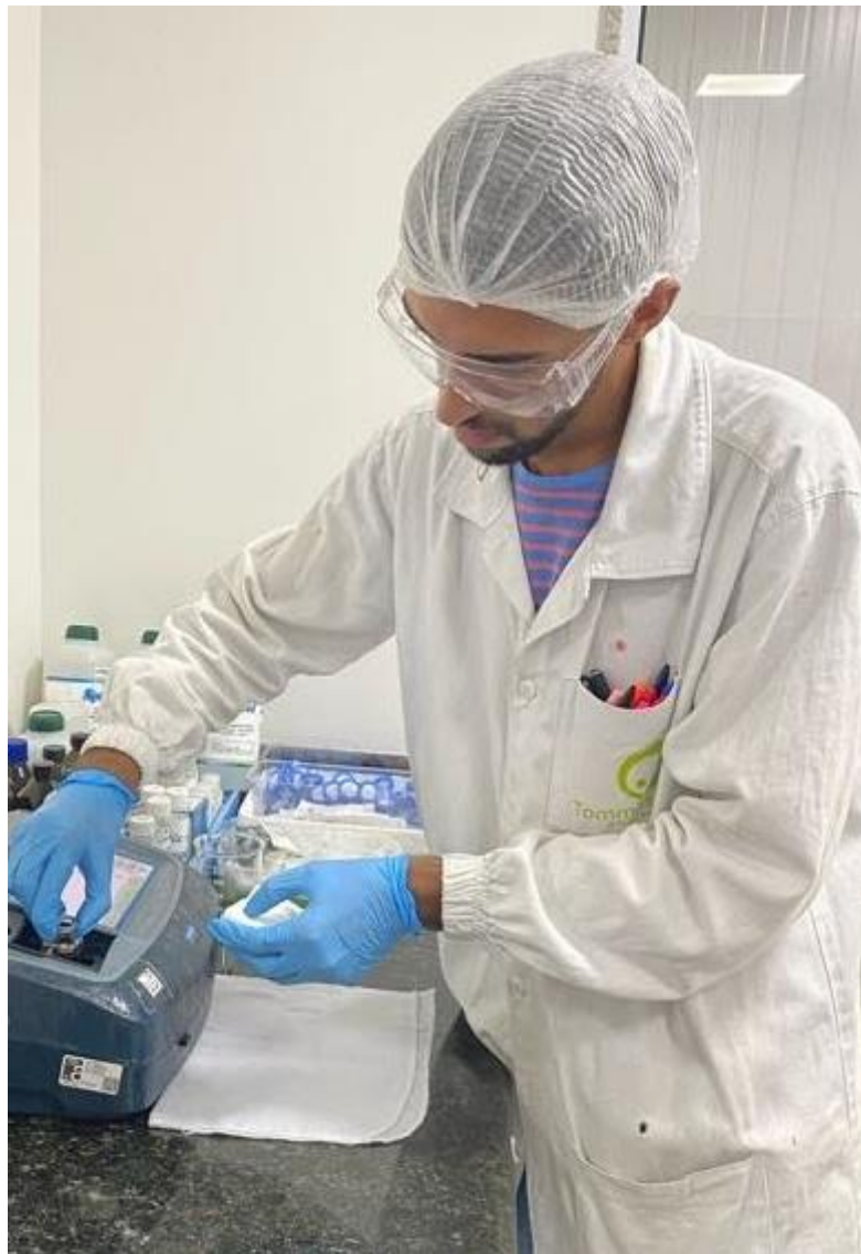
Figura 1. Execução do método espectrofotométrico pelo colaborador do laboratório Tommasi Ambiental.
