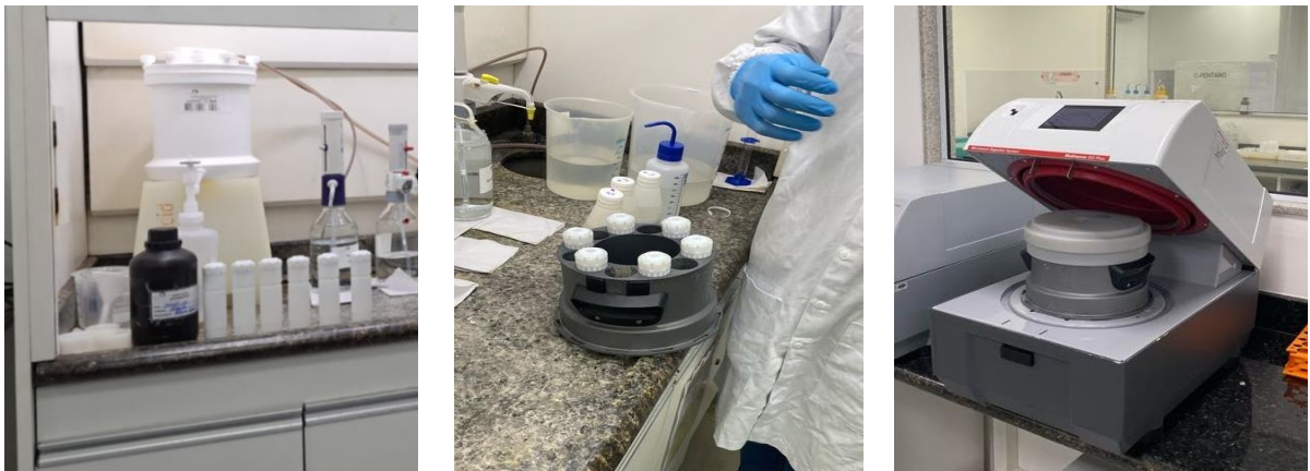
Figura 3. Preparo de amostras para análise de metais totais em ICP OES e ICP MS por radiação microondas.
